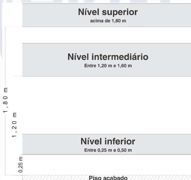
Figura 5 – Níveis de instalação
